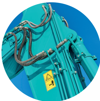
Protection supplémentaire pour les flexibles
